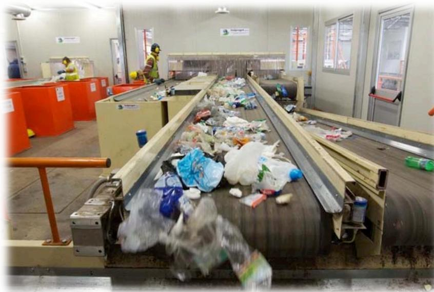
impianti di *screening* per la selezione e recupero della frazione a freddo. Buona parte del residuo è frutto di un errore di progettazione industriale.
